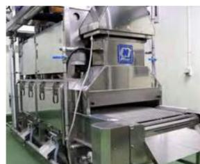
過熱水蒸気式焼成機
